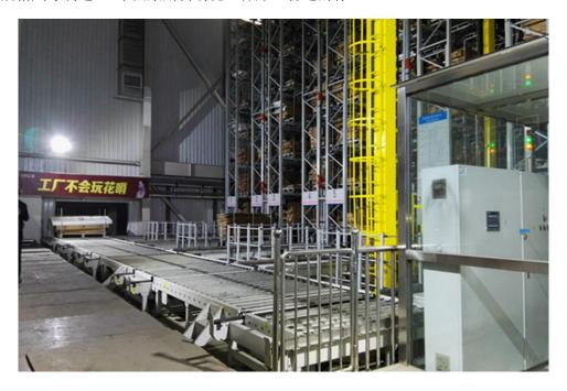
一、节约仓库占地面积,使仓库的空间实现了充分的利用。由于自动化立体仓库采用大型仓储货架的拼装,又加上自动化管理技术使得货物便于查找,因此建设自动化立体仓库就比传统仓库的占地面积小,但是空间利用率大。在发达国家,提高空间的利用率已经作为系统合理性和先进性的重要考核指标。在提倡节能环保的\*\*\*,自动化立体仓库在节约占地资源上有着很好的效果,也是必将使未来仓储发展的一大趋势。二、自动化管理提高了仓库的管理水平。自动化立体仓库采用计算机对货品信息进行准确无误的信息管理,减少了在存储货物中可能会出现的差错,提高了工作效率。同时,立体自动化仓库在入库出库的货品运送中实现机动化,搬运工作安全可靠,减少了货品的破损率,还能通过特殊设计使一些对环境有特殊要求的货品能有很好的保存环境,比如0、易爆的货品,也减少了人在搬运货品时可能会受到的伤害。三、自动化立体仓库可以形成先进的生产链,促进了生产力的进步。专业人士指出,由于自动化立体仓库的存取效率高,因此可以有效地连接仓库外地生产环节,可以在存储中形成自动化的物流系统,从而形成有计划有编排的生产链,使生产能力得到了大幅度的提升。
